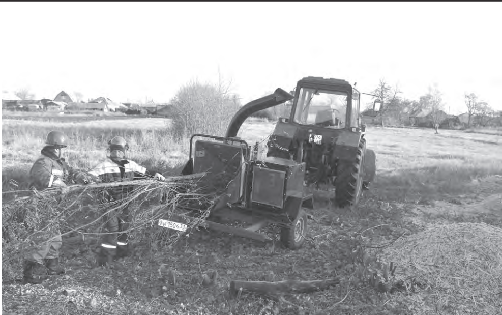
Измельчительная машина превращает ветки в щепу.
