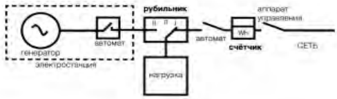
Схема подключения автономного источника питания с использованием автоматики включения резерва электропитания:
