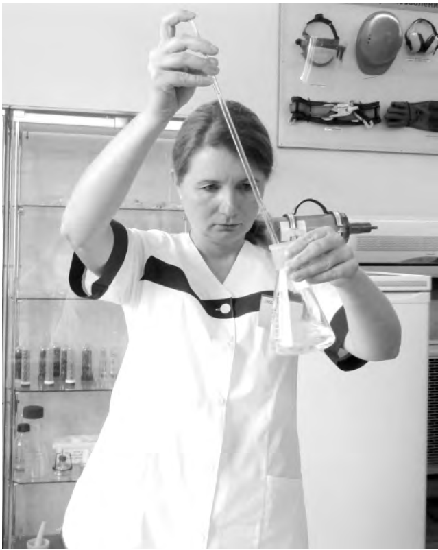
Юлия Костыря делает анализ по определению кислотности числа подсолнечного масла.
