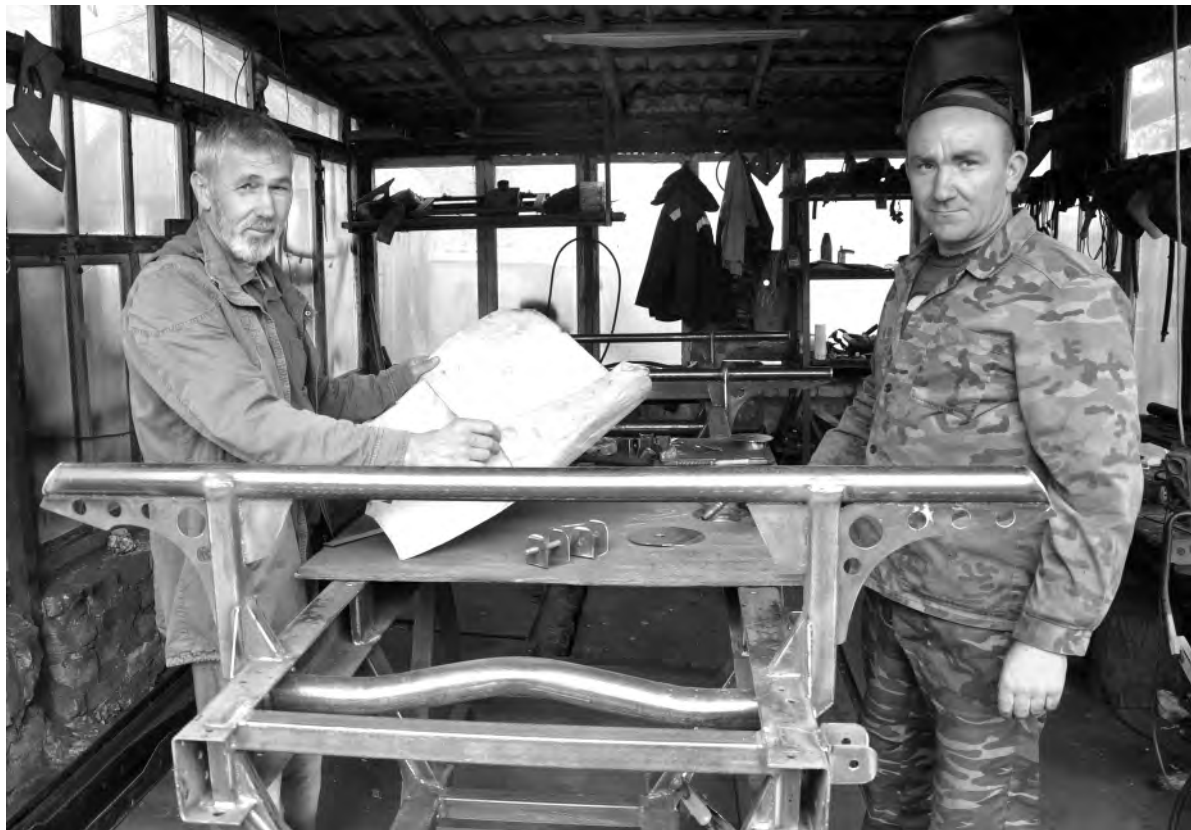
Помощь в сварке рамы пневмохода Виктору Ильминскому (слева) с удовольствием оказывает Михаил Прилуцкий. Без чертежа здесь не обойтись.
